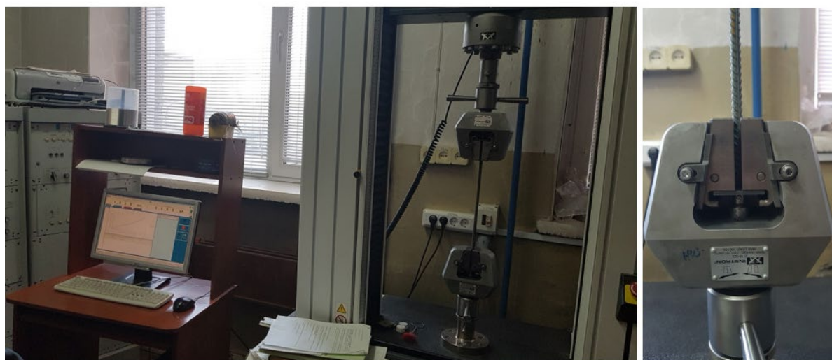
Рисунок 2.6 – Испытания контрольных образцов арматуры на электромеханической машине Instron 3382
