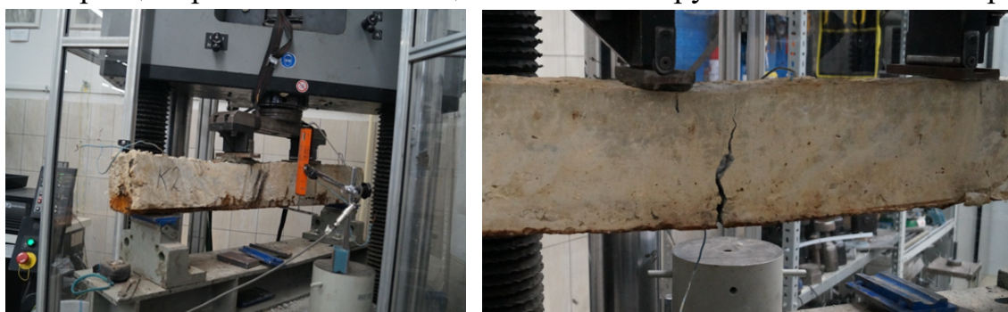
Рисунок 11 – Образцы при испытании на циклическое нагружение
