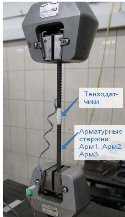
Рисунок 2.7 - Испытания арматурных стержней стали Ø8 класса А500
