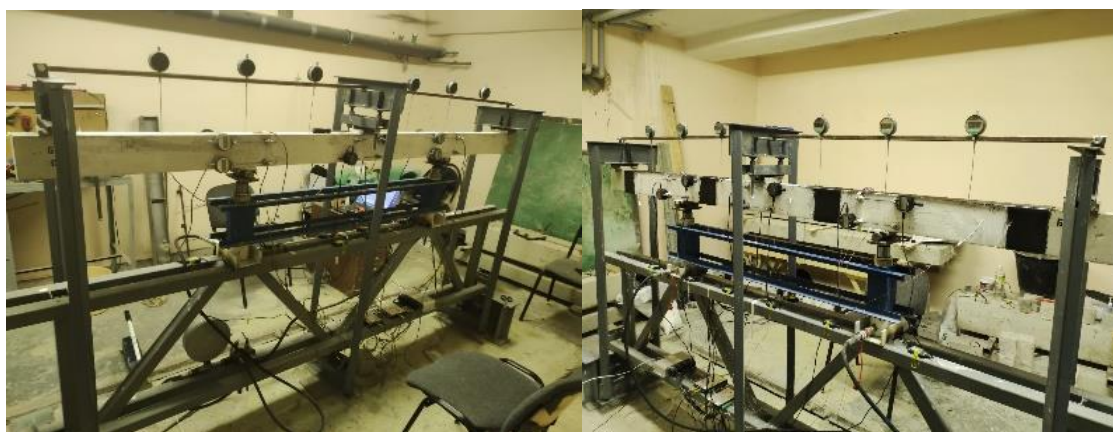
Рисунок 3.15 – Общий вид испытания эталонного и усиленного опытных образцов
