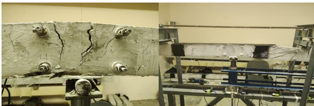
Рисунок 3.16 — Характер разрушения образцов серии БМ
