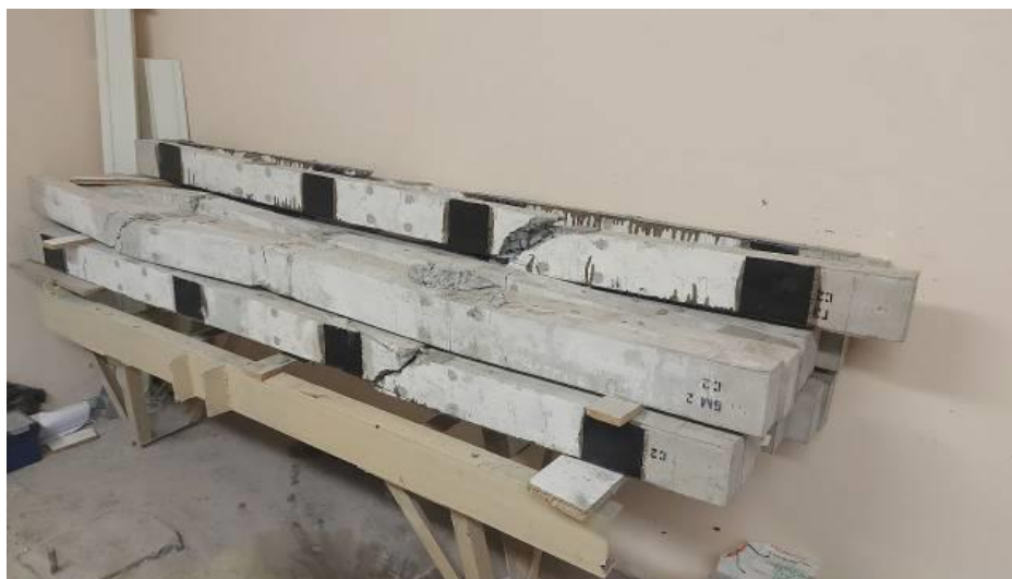
Рисунок 3.17 — Внешний вид балок после разрушения
