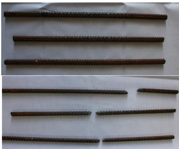
Рисунок 3.9 — Вид образцов металлической арматуры до и после испытания
