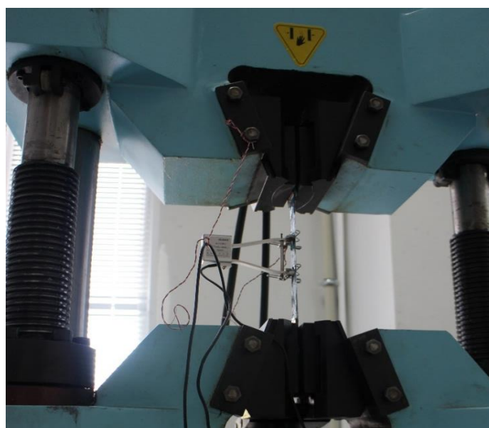
Рисунок 3.13 — Испытание образца углепластика на растяжение
