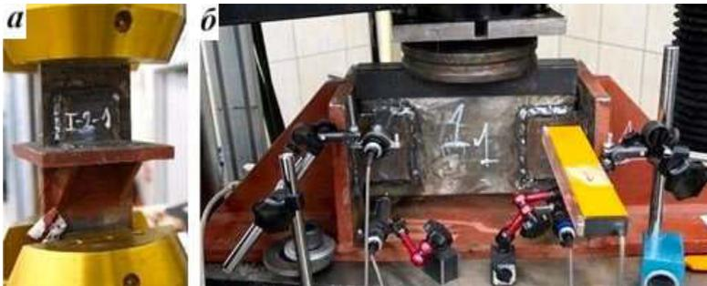
Рисунок 5 – опытные образцы в испытательных установках: для испытания на растяжение (а), для испытания на сдвиг (б)
