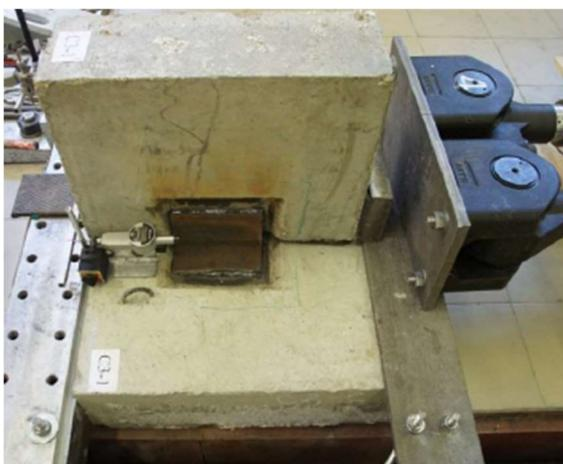
Рисунок 1.16 – общий вид стыка стеновых панелей на закладных деталях с гнутым уголком
