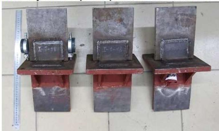
**Серия I-2. Образцы с гнутыми уголками 75x50x6 до испытания**
