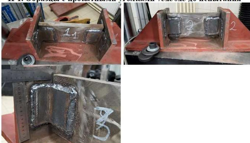
Рисунок 3.4 – Опытные образцы до испытания на сдвиг
