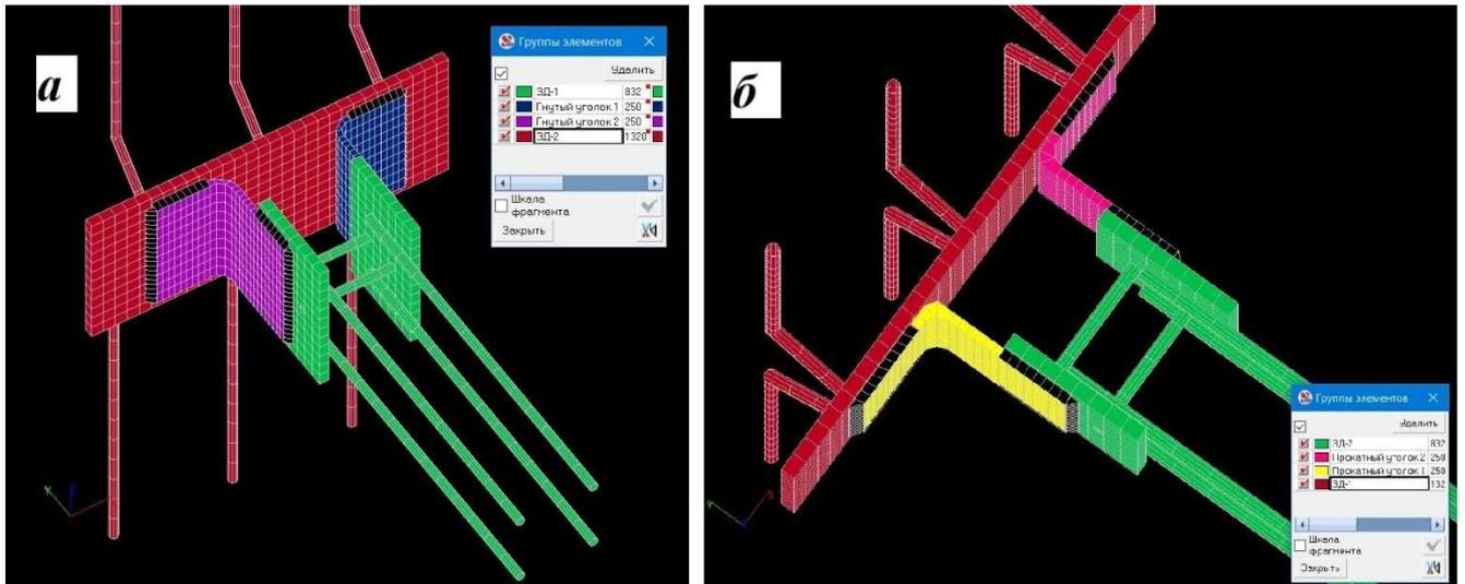
Рисунок 2.11 – расчетная схема соединения: закладных деталей с гнутыми уголками (а), закладных деталей с прокатными уголками (б)
