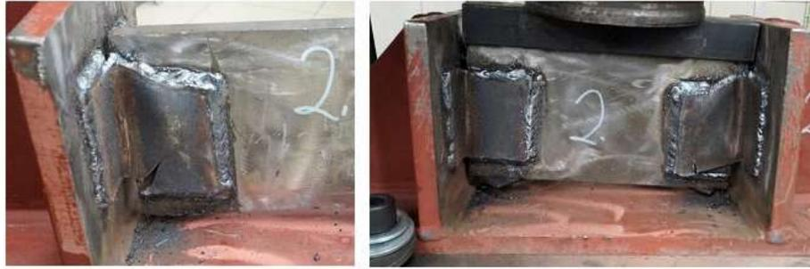
Разрушение образца П-1-3
