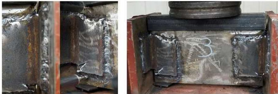
Рисунок 3.30 – Характер разрушения опытных образцов серии П-1 с прокатными уголками с размерами 75x50x5 мм при вертикальном сдвиге
