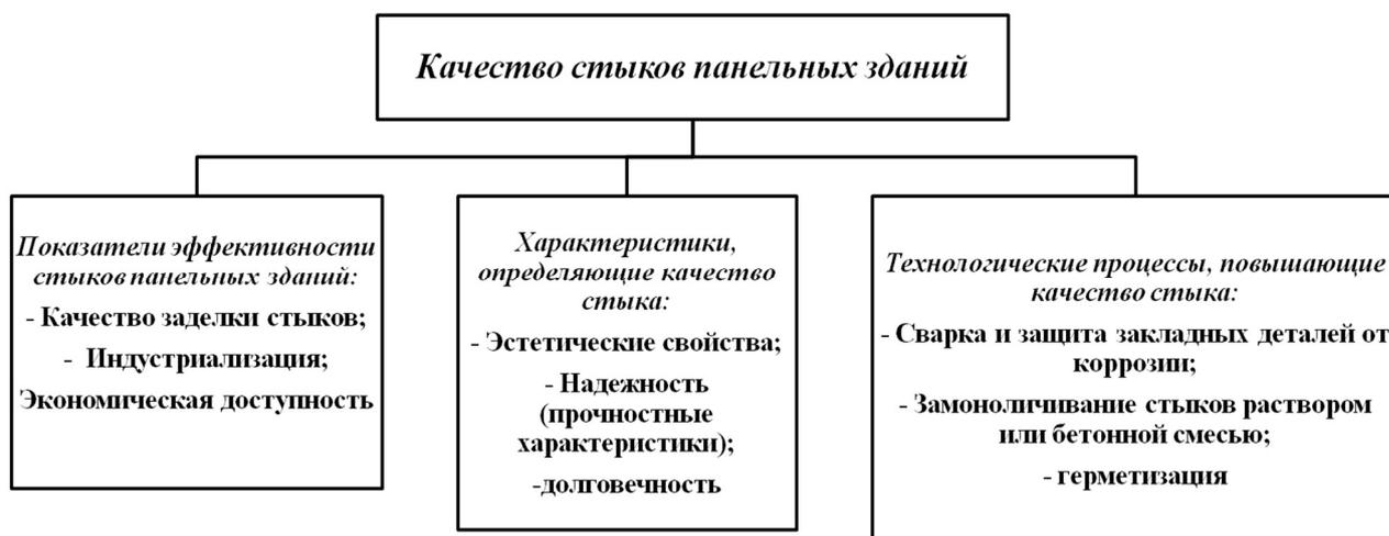
Рисунок 1.8 – Основные критерии качества стыков крупнопанельных зданий
