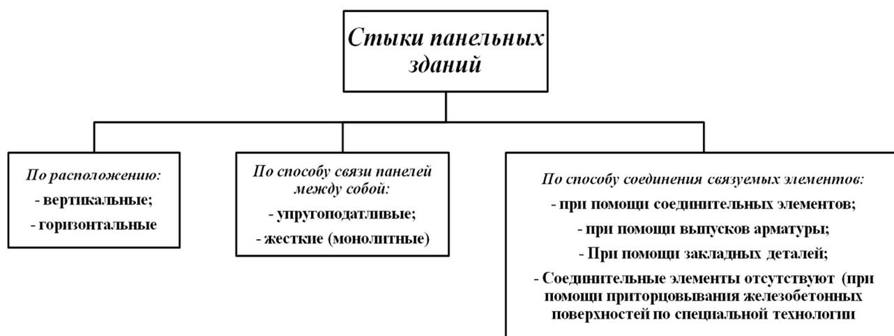
Рисунок 1.1 – Общая классификация стыков панельных зданий
