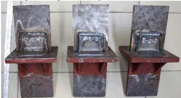
Рисунок 3.3 – Опытные образцы до испытания на растяжение
