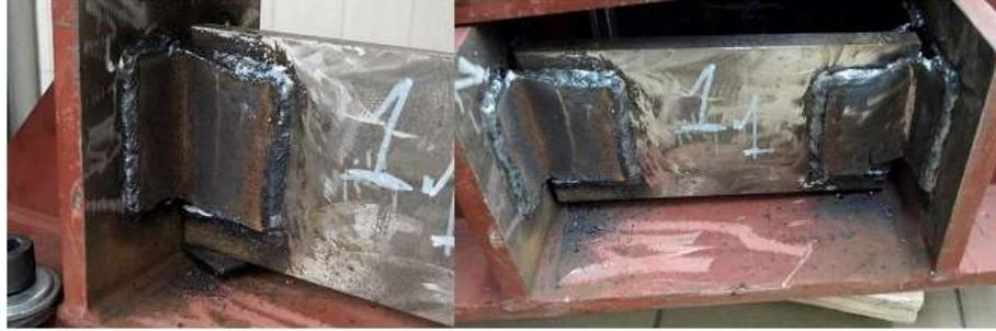
Разрушение образца П-1-2
