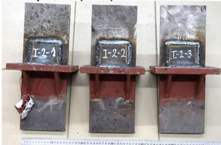
**Серия II-2. Образцы с прокатными уголками 75x50x6 до испытания**
