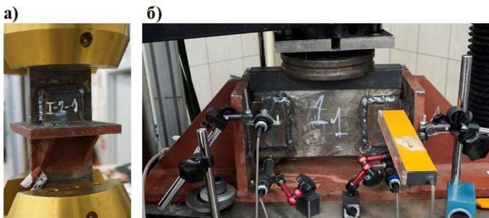
Рисунок 3.8 – Опытные образцы на испытательном стенде до испытания: а) на растяжение, б) на сдвиг
