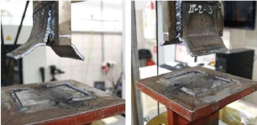
Рисунок 3.21 – Характер разрушения опытных образцов серии П-2 с прокатными уголками с размерами 75x50x6 мм при растяжении
