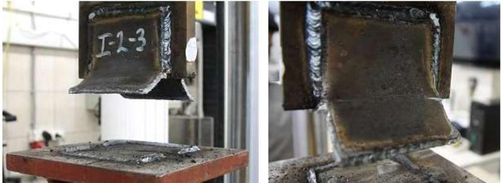
Рисунок 3.20 – Характер разрушения опытных образцов серии I-2 с гнутыми уголками с размерами 75x50x6 мм при растяжении
