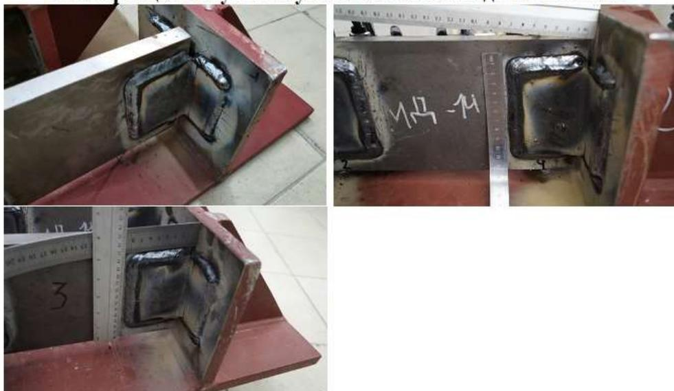
**II-1. Образцы с прокатными уголками 75x50x5 до испытания**
