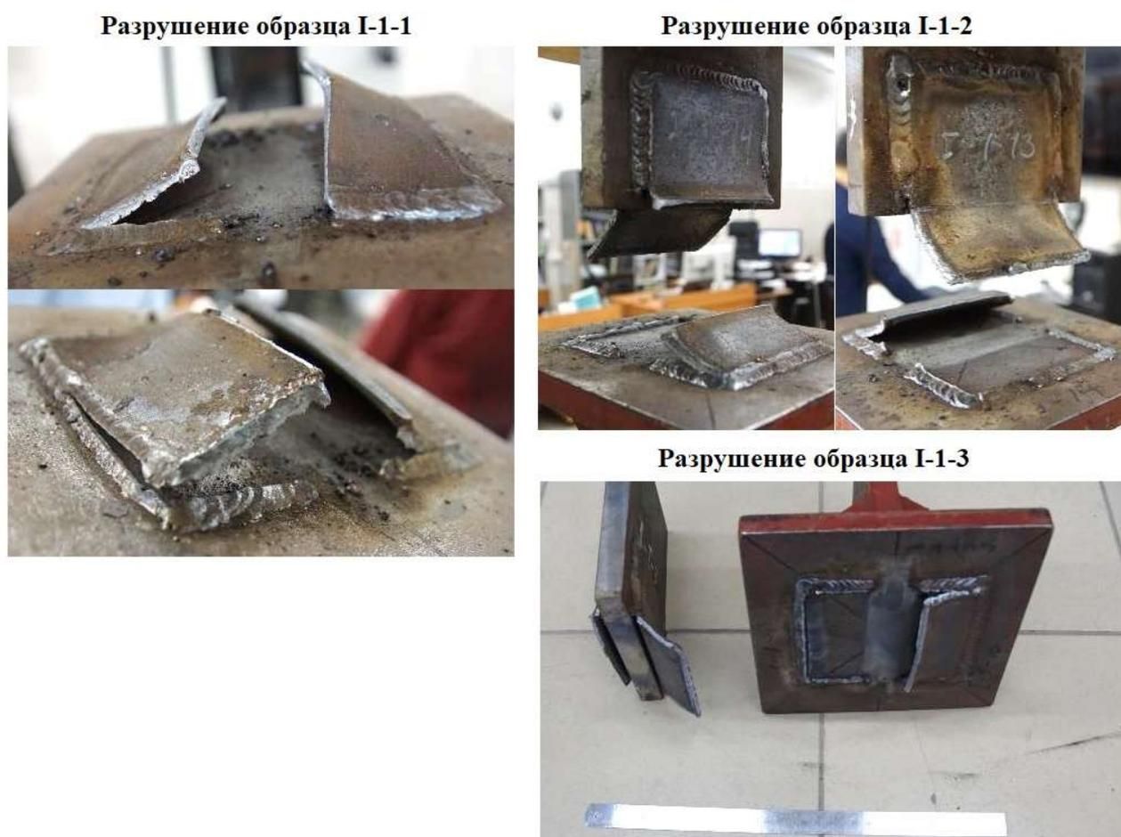
Рисунок 3.12 – Характер разрушения опытных образцов серии I-1 с гнутыми уголками с размерами 75x50x5 мм при растяжении
